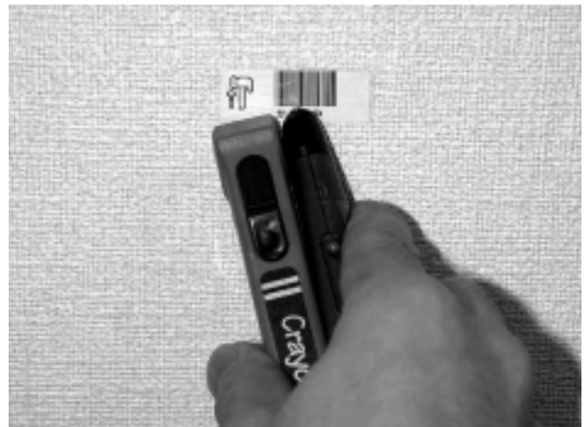
図2. Scroll Browserの指示装置部。ペン型マウスとバーコードリーダーが一体となった構造をしている。壁のバーコードを原点とした二次元位置を検出する。
