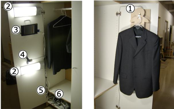
図 7: タグタンク: (1) フックセンサーの他に、(2) 照明 (3) ディスプレイ (4) カメラ (5) リードスイッチ (6) PC などが組み込まれたタンク。
