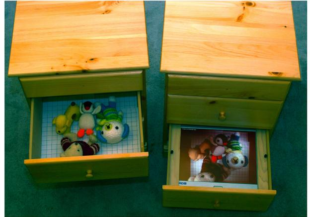
図 5: Peek-A-Drawer: ネットワーク接続したキャビネットの上の引き出しの内容が、もう一方の下の引き出しのディスプレイに表示される。
