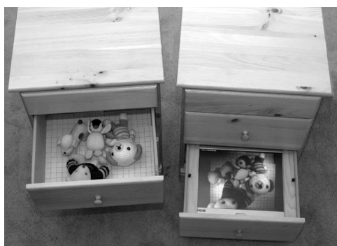
図 5 Peek-A-Drawer： ネットワーク接続したキャビネットの上の引き出しの内容が、 もう一方の下の引き出しのディスプレイに表示される。
