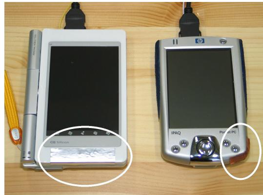
図 2 文鎮メタファーのためのセンサを実装した 2 種類の試作機。左は丸印で示したタッチセンサ電極を画面下部中央に設置し、右は右下部に設置した。
