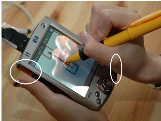
図 7 利き手（右手）の手のひらが当たる部分（右円内）と、非利き手（左手）の親指があたる部分（左円内）にタッチセンサをつけた試作機。評価実験用プログラムが動作している。
