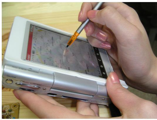
図 3 上はセンサ(内)に触れずにドラッグすることでスクロールしているところ、下はセンサに触ることで手書きメモ入力しているところ。
