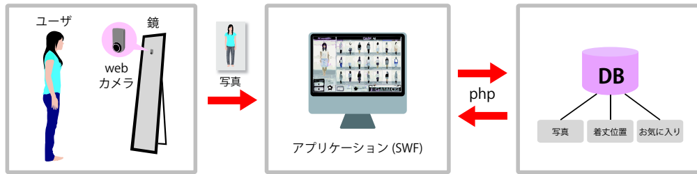
図 2 suGATALOG のシステム構成 Fig. 2 The system architecture of suGATALOG
