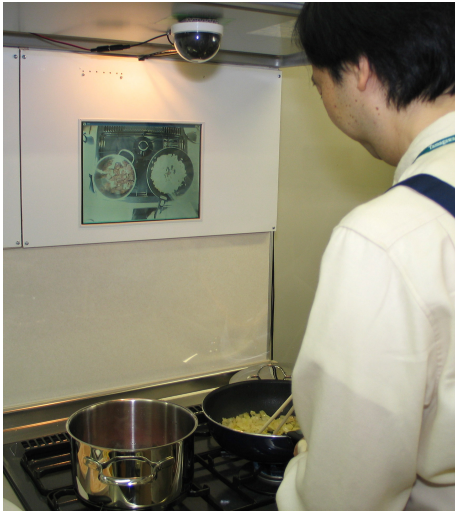
図 4. 調理を記録している様子。足元スイッチの操作で、上方のカメラを使って手元の写真を撮影し、音声メモを記録する。
