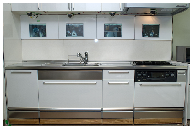
図 1. Kitchen of the Future システム全体像。吊り戸棚の下にカメラとマイクロフォン、壁に LCD、足元にスイッチが組み込まれている。
