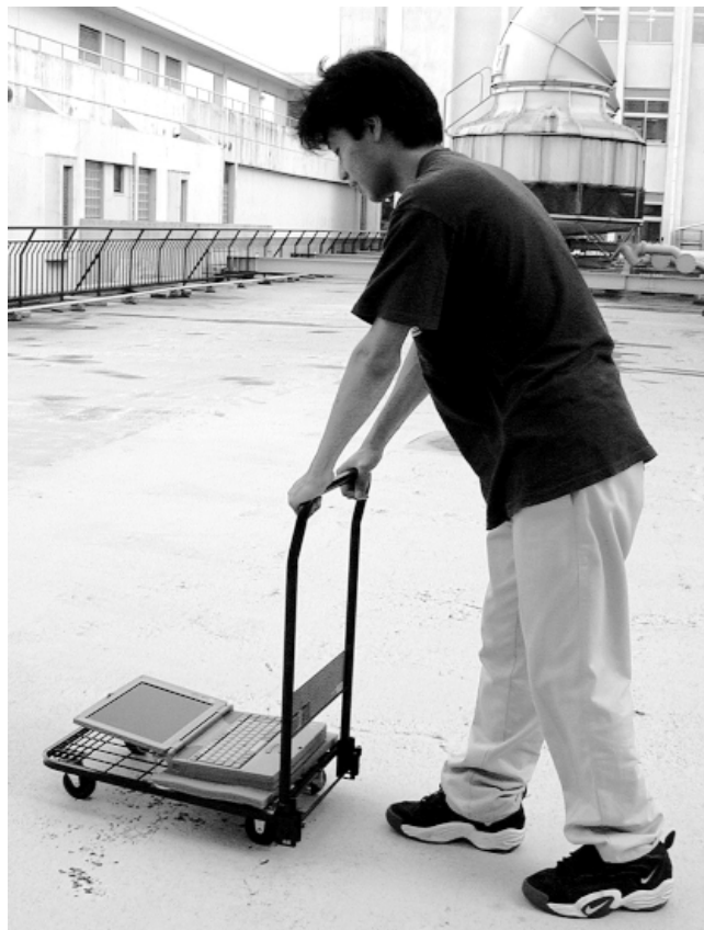
図 1. Virtual Glassboat。カートに搭載されたコンピュータ画面が、移動方向と逆にスクロールする。
