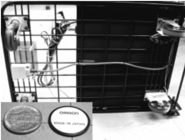
図2 カートの底面。後輪(右)の回転を測定する。また先頭部分(左)にはRFIDリーダが取り付けられ、床の上のRFIDタグ(左下)を読みとる。
