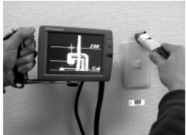
図4. Absolute Mouseを使った簡易型拡張現実システム、Scroll Browserの全景。壁のバーコードを読み取った後、Absolute Mouseを壁に当てたまま動かすと、その場所の情報(図では、壁の中の電気配線の様子)が手元の表示装置に表示される。
