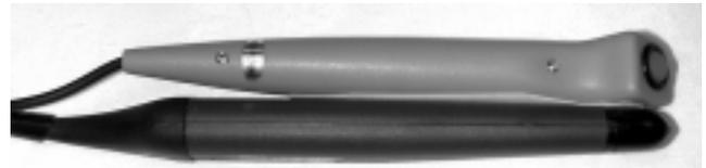
図1. Absolute Mouseの例。ペン型マウスとバーコードリーダを接着した。物の表面に貼られたバーコードを読み取り、これを原点とした二次元位置を検出する。
