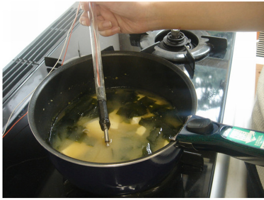
図1 鍋に塩分センサを入れて測定している様子。 Fig. 1 Measuring salinity of soup in a pot.
