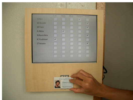
図 4 電子行き先掲示板 . ID カードを持っているユーザだけが自分のマークを移動可能 .
