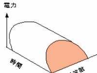
PN (擬似音声) と呼ばれる電波に信号を乗せ、周波数帯の全幅に拡散して送る。
