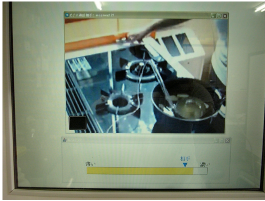
図4 実際の表示例．相手側の映像と塩分濃度バーグラフが表示される．
