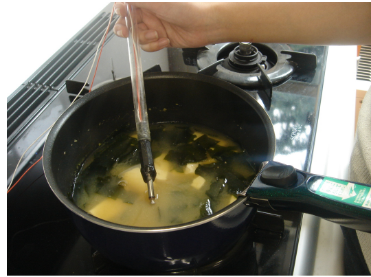
図 6 鍋に塩分センサを入れて測定している様子。
